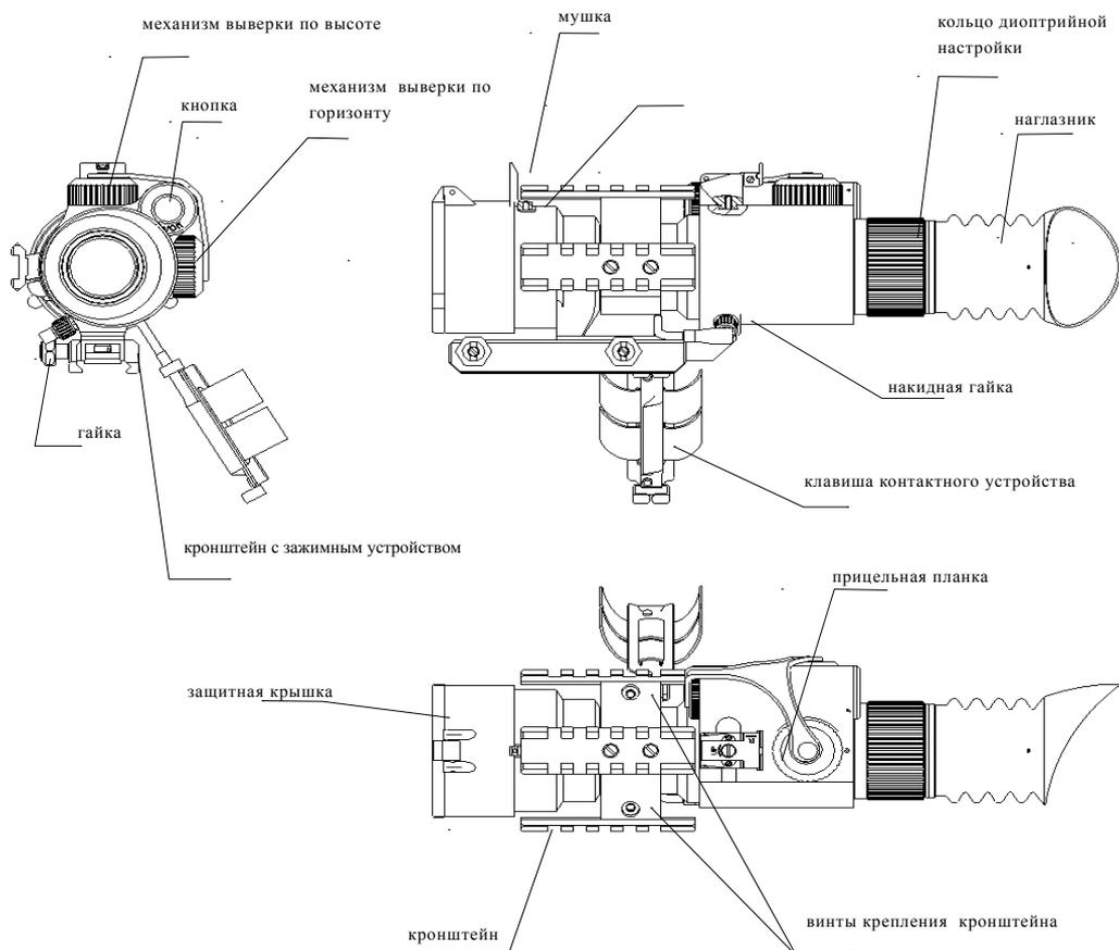
**РИСУНОК А.3** ЗАЖИМНОЕ УСТРОЙСТВО. ВИД СНИЗУ
